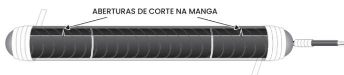
Posicione a cabeça da câmera no centro do packer e transfira a medição com fita adesiva do cabo da câmera para as hastes pneumáticas.
